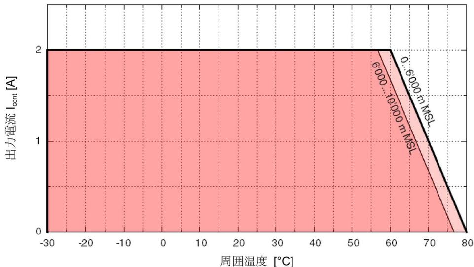
図 2-1 ディレーティング、出力電流
