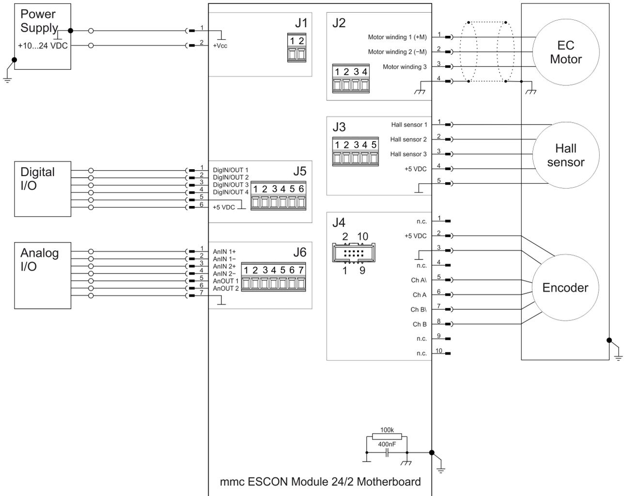
図 5-41 ESCON モジュール MoBo : maxon EC motor、ホールセンサおよびエンコーダ付き (J2 / J3 / J4)
