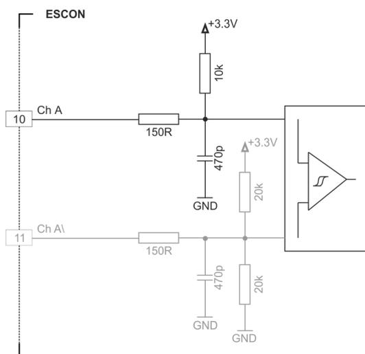
図 3-7 エンコーダ入力回路 Ch A 「単一端」 (Ch B も同様)
