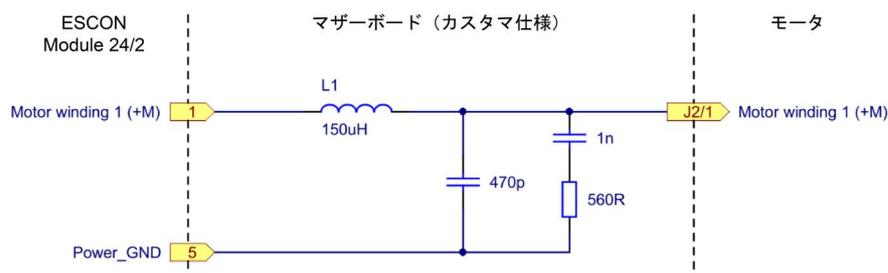
図 5-26 モーター巻線 1 の接続 (モーター巻線 2、3 も同様)
