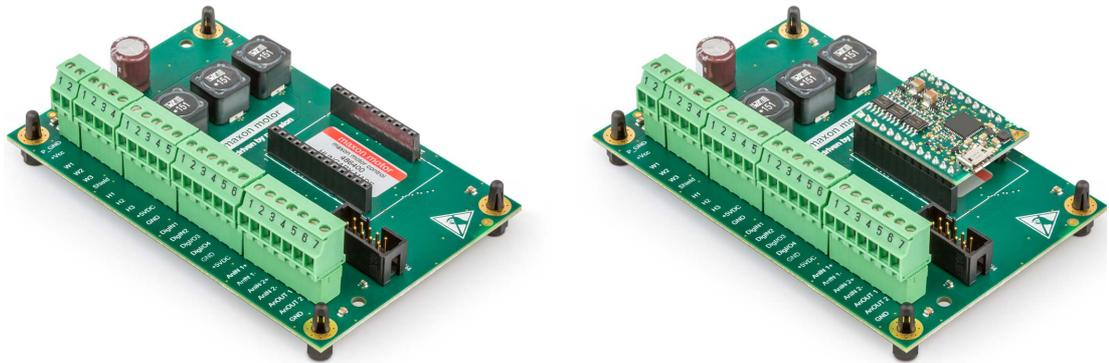
図 5-28 ESCON モジュール MoBo (左)、ESCON モジュール 24/2 を取り付けた状態 (右)
