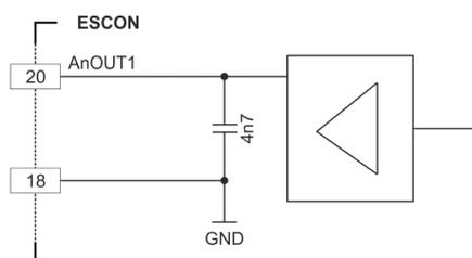
図 3-14 AnOUT1 回路 (AnOUT2 も同様)
