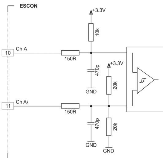
図 3-6 エンコーダ入力回路 Ch A 「差動」 (Ch B も同様)
