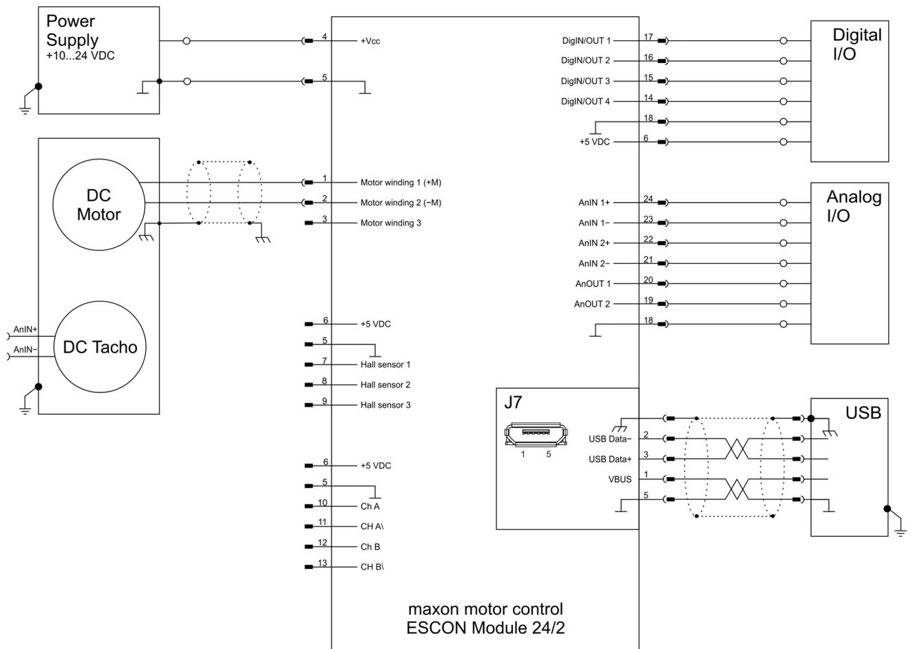
図 4-19 maxon DC motor、DC タコ付き
