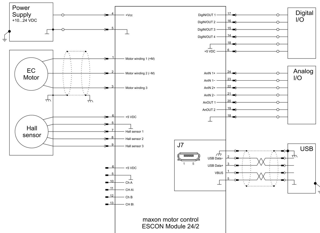
図 4-21 maxon EC motor、ホールセンサ付き
