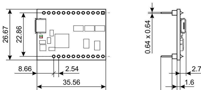
図 2-2 外形寸法図 [mm]
