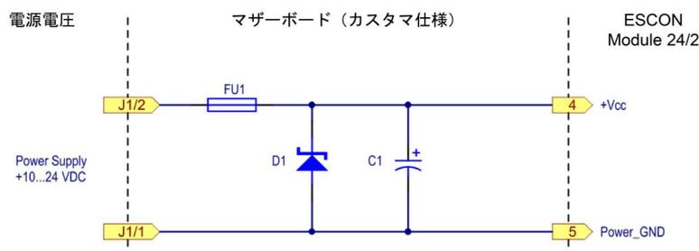
図 5-23 電源電圧ケーブルの接続
